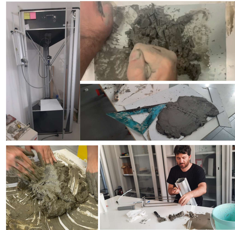
Fig. 4.f – Preparazione impasto in argilla per stampa con 3D Wasp 4070. Fonte: elaborazioni per tesi phd D.Lucanto (ABITAlab)
