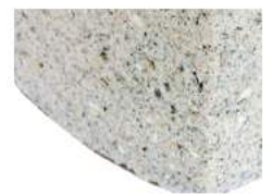
Massetto alleggerito con polimeri riciclati dosato a 300kg/mc di cemento ECOMIX
