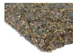
Massetto alleggerito con polimeri riciclati dosato a 150kg/mc di cemento ECOLIGHT
