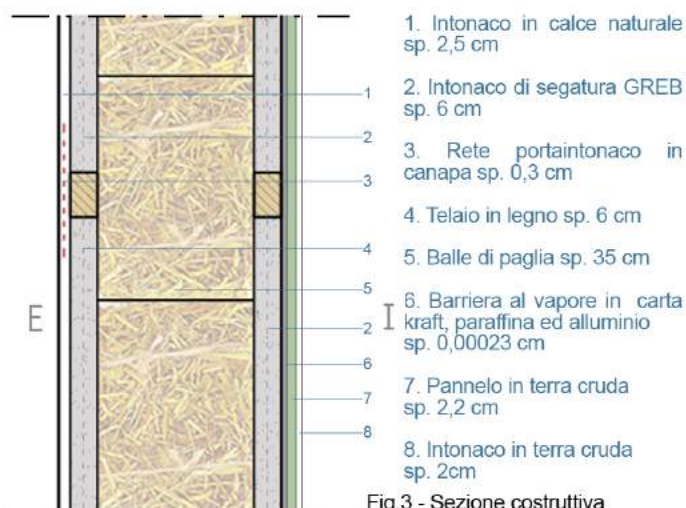
Fig. 3 - Sezione costruttiva
