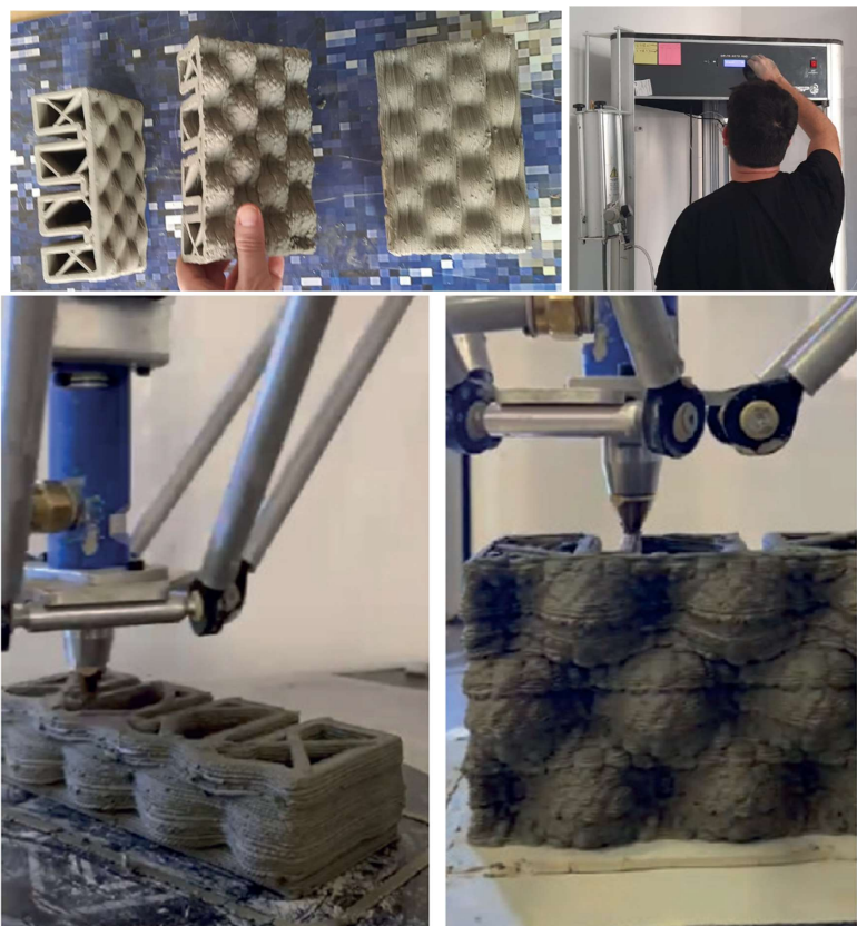
Fig. 4.g – Fasi di stampa 3D del prototipo. Fonte: elaborazioni per tesi phd D.Lucanto (ABITAlab)
